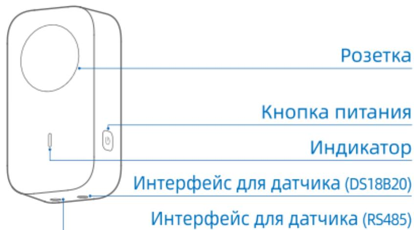
Примечание: Интерфейс датчика - аудиоразъём 3,5 мм.
